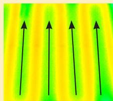
L'adhésif standard pour carrelage montre les points froids entre les fils
