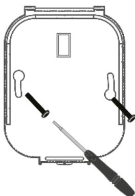
Insérez les vis de fixation dans les trous de montage de la base d'alimentation et serrez.
