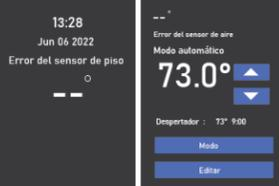
Si el termostato no se restablece a los valores normales después de un ciclo de alimentación (apagar y encender el termostato), significa que el sensor ha fallado y debe ponerse en contacto con el instalador o electricista instalador o electricista.
