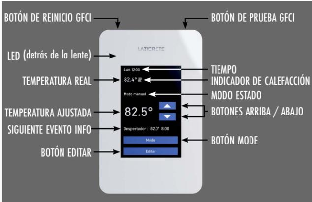
programado para llevar la temperatura ambiente a la temperatura establecida en la siguiente hora del evento de forma más eficiente. Tenga en cuenta que cuando active la función adaptativa por primera vez, el termostato tardará unos días en aprender el tiempo preciso de encendido y apagado necesario. Siempre mantenga los orificios de ventilación de la parte posterior del módulo de potencia limpios y libres de obstrucciones como pintura o silicona.
