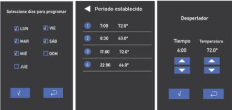
Para programar un horario, seleccione los días que desea programar, elija el periodo y, a continuación, ajuste la hora de inicio y la temperatura deseadas para el periodo la hora de inicio y la temperatura deseadas para el periodo. Repita estos pasos hasta completar el programa.
