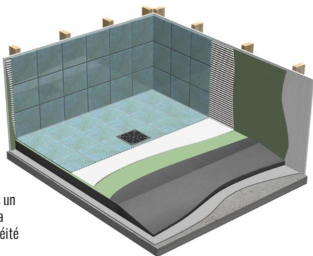
Rampe formée dans un mortier-colle avec la membrane d'étanchéité HYDRO BAN
